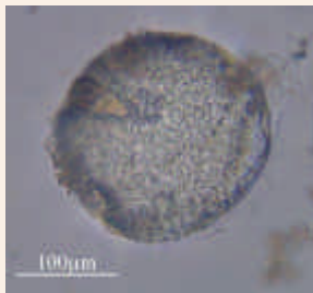
capsule en PEU milieu CO_2 liquide (observation MO)
